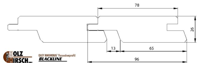
Abmessung: **26x96mm** Deckbreite der Profile 78mm
