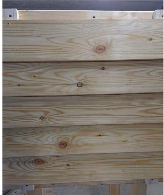
Abmessung: 26x144mm (Deckbreite der einzelnen Bretter 122mm)
